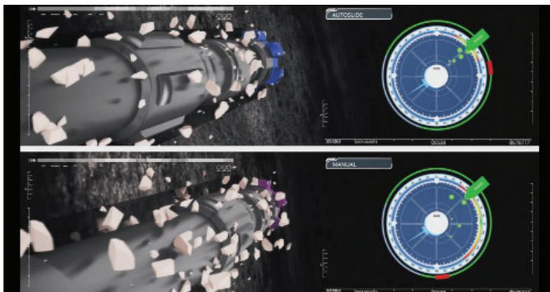
**AUTOSLIDE® ES UN CONJUNTO DE SERVICIOS DE PERFORACIÓN QUE AUTOMATIZA EL CONTROL DE EQUIPOS DE SUPERFICIE Y MOTORES DE FONDO PARA OPTIMIZAR EL DESLIZAMIENTO EN LA PERFORACIÓN DE POZOS DESVIADOS Y HORIZONTALES.**
